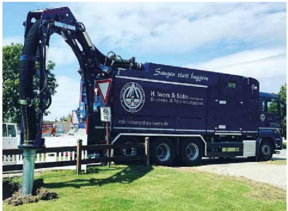
Schonend: Durch das gummierte Werkzeug hinterlässt der Saugarm keine Schäden im Erdreich. (Foto: Iwers)
